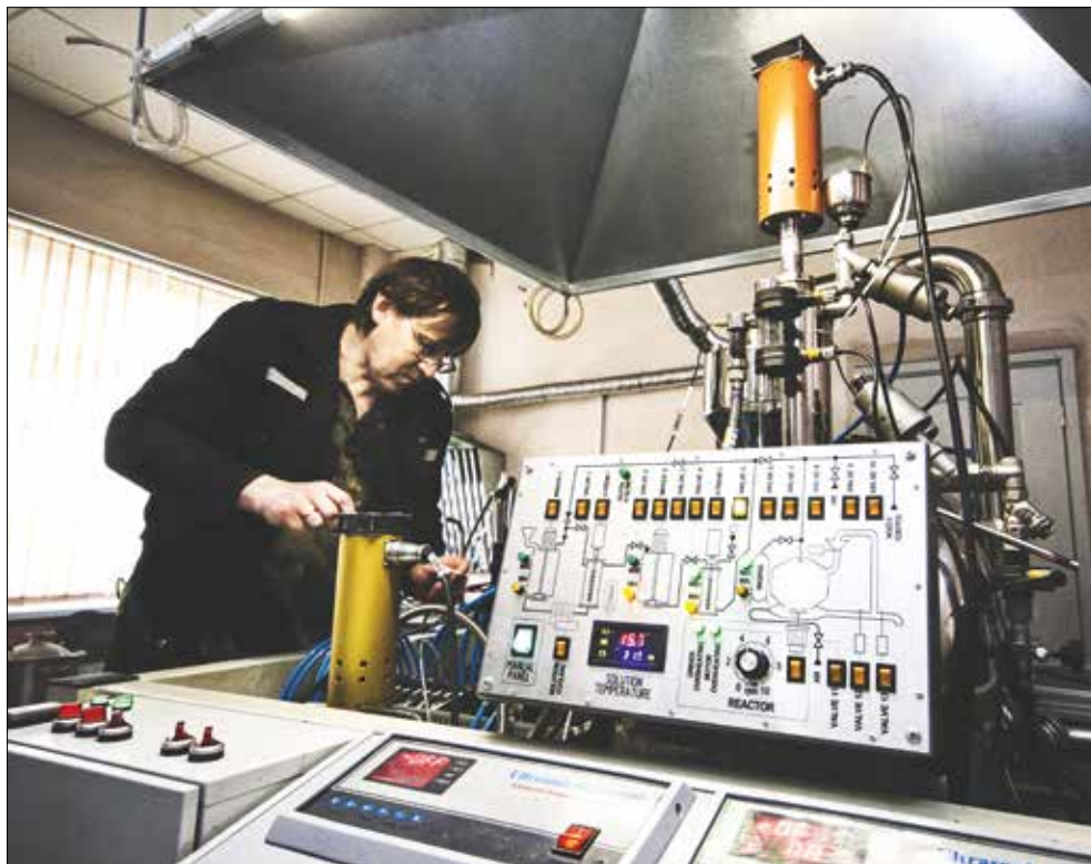
Установка для нанесення нанотрубок виготовлена в університеті на замовлення фірми Tim-Trede (Чеська Республіка)
