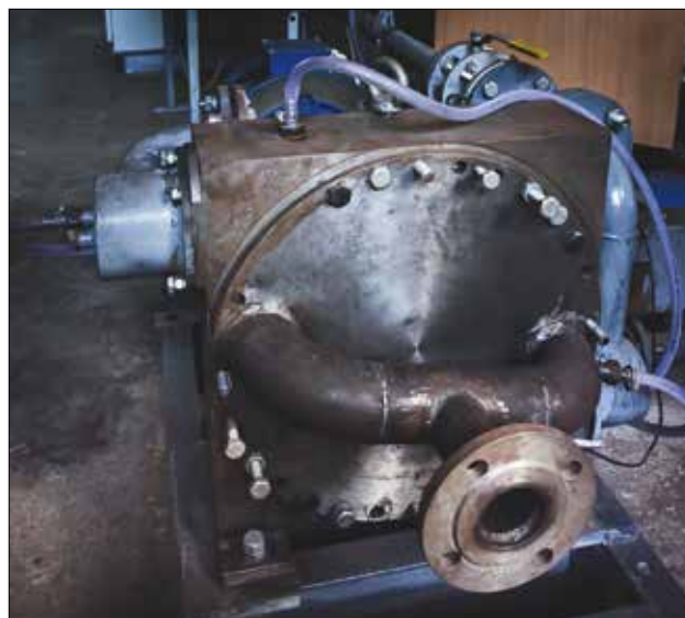
Турбодетандер для перетворення енергії стислого газу в електричну – розробка та виготовлення кафедри «Технічної теплофізики»
