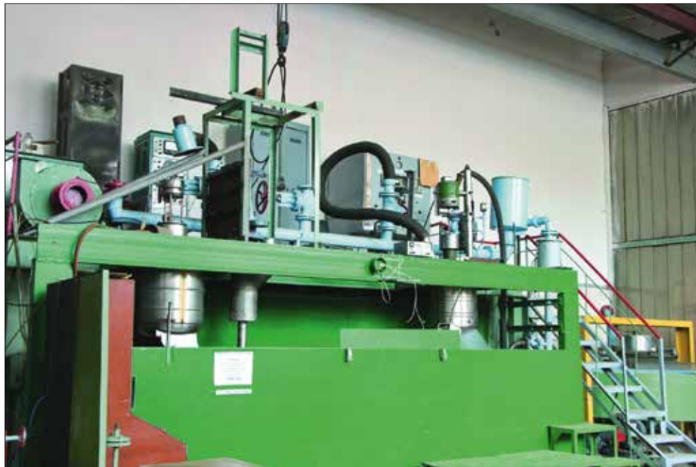
Один із перших стендів дослідження процесів грануляції мінеральних добрив
